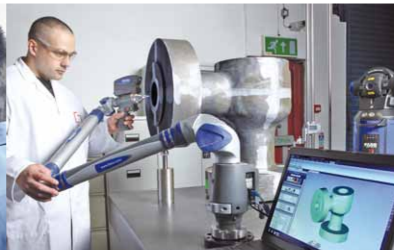
Mittels Laserscanning kann Goodwin das Werkstück mit dem CAD-Modell abgleichen.
