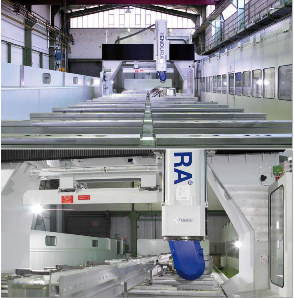
der Herstellungsprozess: Dem Gießen des Alu-Rohbarrens für die Strangpresse und Pressen des Profils schließt sich das Richten und Thermisches Auslagern (Thempnen) an, bevor die Profile eventuell zu größeren Rohteilen zusammenschweißt werden und die CNC-Bearbeitung erfolgt. Bei Bedarf sind daraufhin erneut Schweißarbeiten und nochmalige CNC-Bearbeitung erforderlich. Die tagtäglich enge Verzahnung von Schweißarbeiten und CNC-Bearbeitung findet ihre
