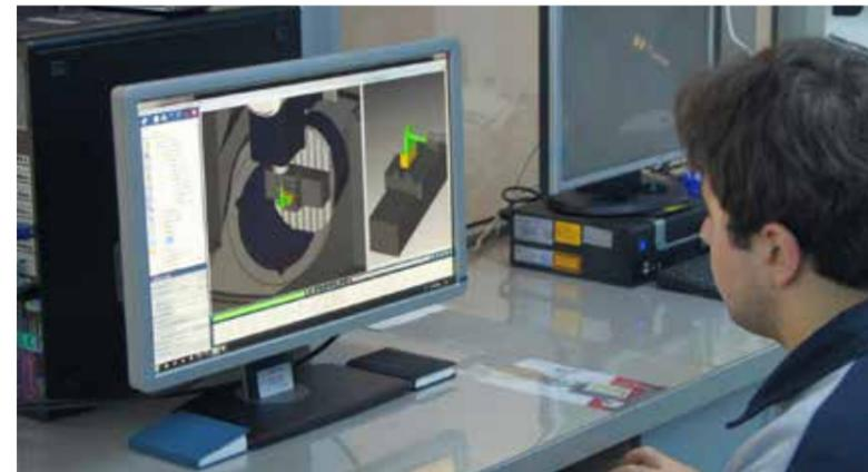
sich Probleme abzeichnen, sind wir bereit, sofort gegenzusteuern.“ Aus diesem Grund entschied sich Hexagon Ortho auch für VERICUT®, die CGTech-Software zur Simulation und Verifikation von NC-Programmen. Mit der Validierung des von der Bearbeitungsmaschine verwendeten NC-Codes nach dem Postprozessorlauf minimiert Hexagon Ortho die Risiken einer Kollision und vermeidet Folgeschäden an Schneidwerkzeugen und den zu bearbeitenden
