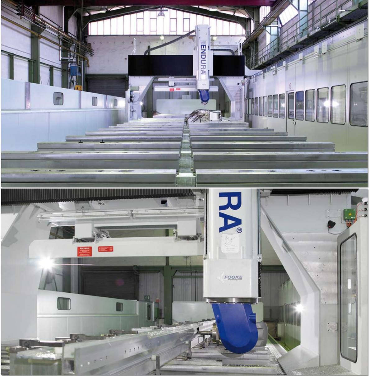
der Herstellungsprozess: Dem Gießen des Alu-Rohbarrens für die Strangpresse und Pressen des Profils schließt sich das Richten und Thermisches Auslagern (Thempn) an, bevor die Profile eventuell zu größeren Rohteilen zusammenschweißt werden und die CNC-Bearbeitung erfolgt. Bei Bedarf sind daraufhin erneut Schweißarbeiten und nochmalige CNC-Bearbeitung erforderlich. Die tagtäglich enge Verzahnung von Schweißarbeiten und CNC-Bearbeitung findet ihre
