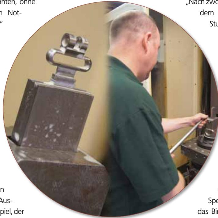
Funktionalität lässt sich das Teil in einem Durchlauf bearbeiten, danach erfolgt das Drahterodieren am Reststück, ehe die Oberfläche erodiert wird. Im Übrigen werden alle komplexen Kupfer-Elektroden für das Senkerodieren inhouse hergestellt.
