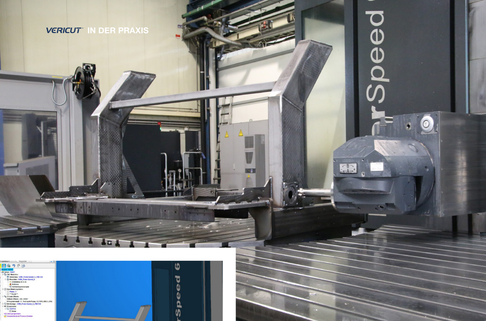
Die echte und die virtuelle Maschine sind bei Lisec vollkommen ident. Somit können alle Fertigungsprozesse bereits im Vorfeld am PC simuliert werden.
